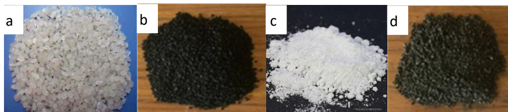
Fig.( 1):- (a) HDPE, (b) NFC, (c) Al 2 O 3 and (d) MCA.
