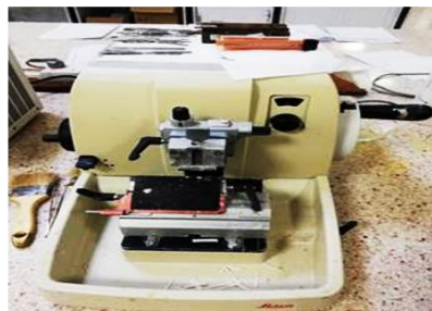
Fig. (5): Manual Microtome LIECARM–2235
